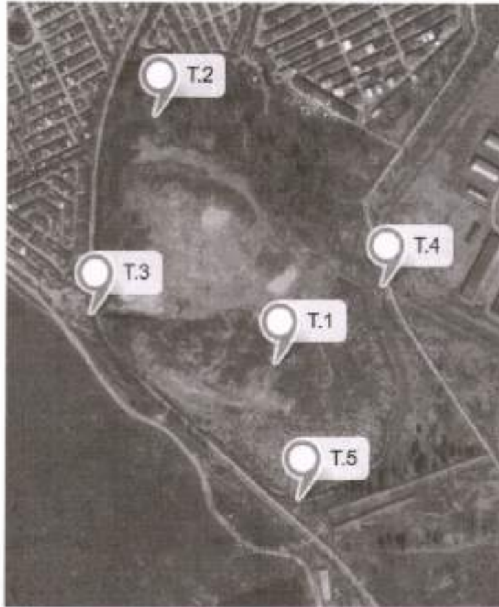
Рис. 1. Общий план исследуемого участка с точками мест проведения измерений шума, инфразвука, ЭМИ и вибрации.
