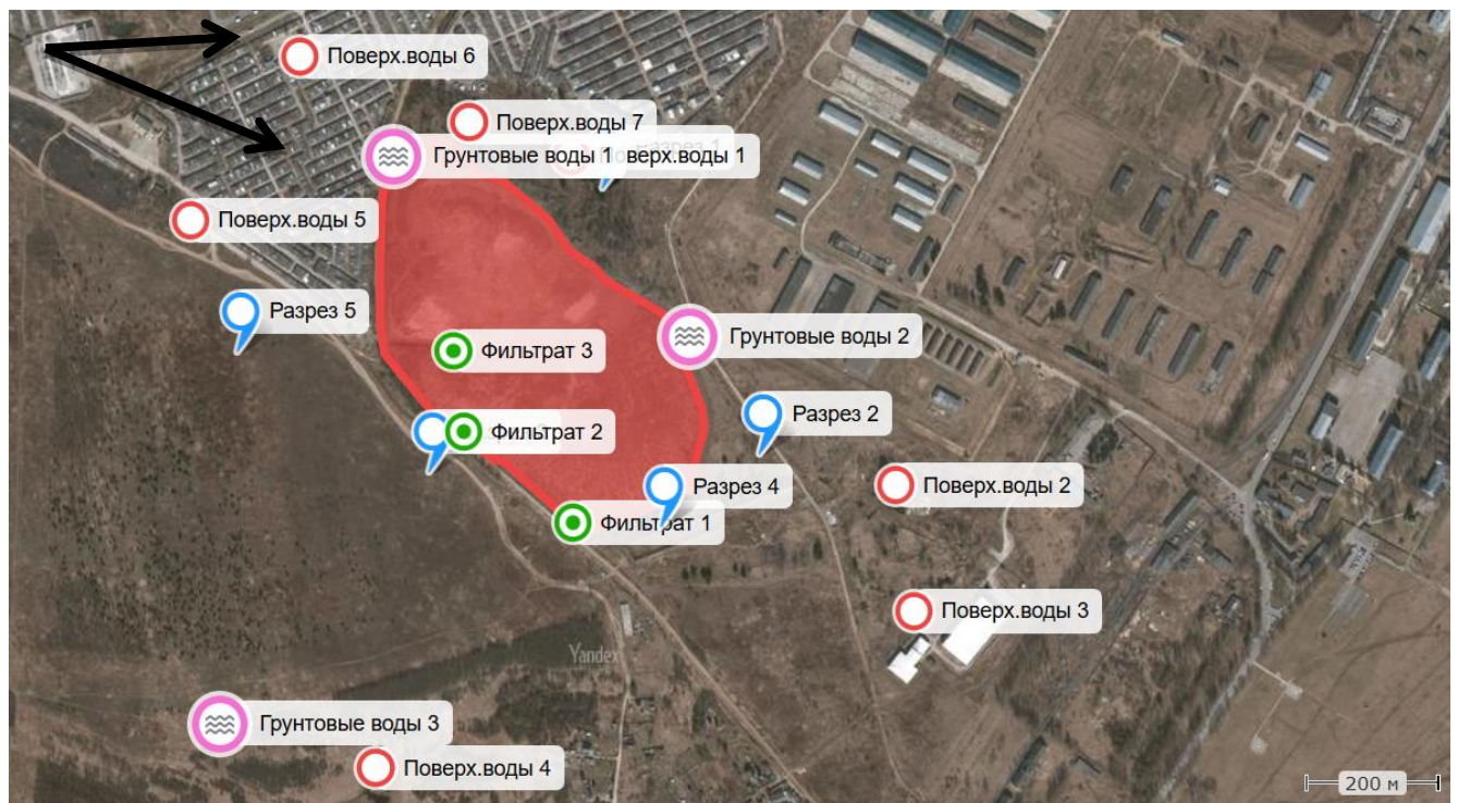
Рис. 3.5.1 Схема отбора проб почв на агрохимические исследования (5 разрезов), грунтовых вод из скважин до глубины 5,5 м (3 пробы), поверхностных вод и донных отложений (7 проб), а также проб фильтрата ТКО (3 пробы). Стрелками указано направление движения грунтовых вод.
