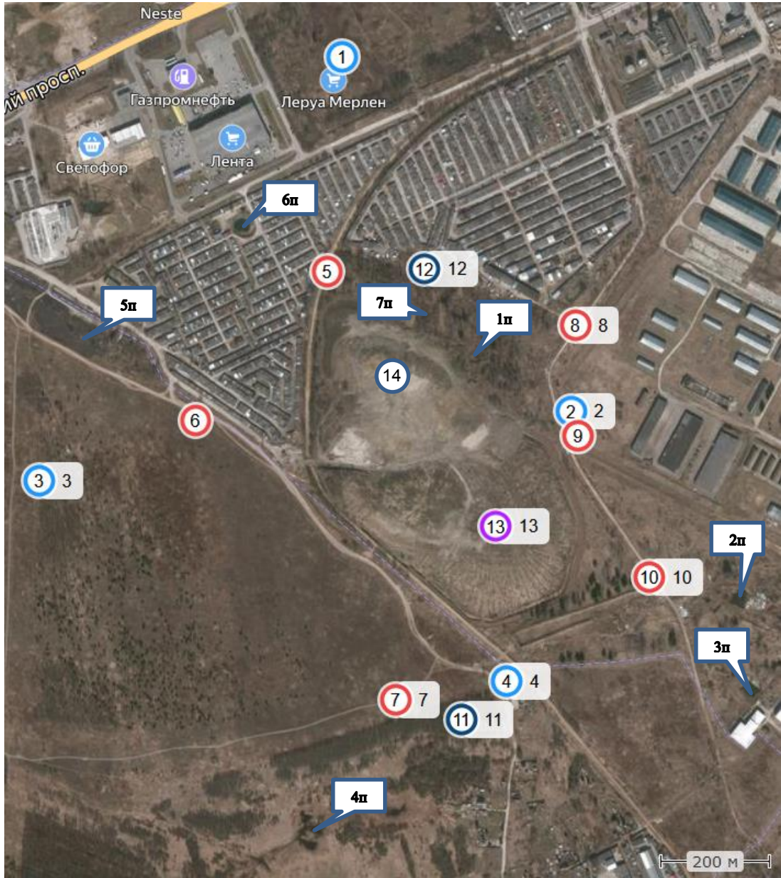
Рис. 6.7.1 - Схема расположения точек мониторинга атмосферного воздуха, акустического воздействия, почв, грунтовых (подземных) вод и техногенных грунтовых вод (при их наличии): № точек – пояснения в тексте
